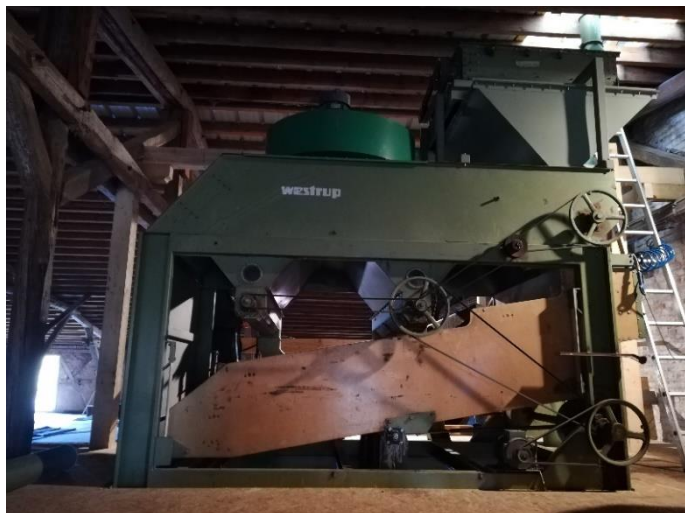
Abbildung 7: Siebanlage (linkes Bild) und Trieurmäntel (rechtes Bild) der Saatgutaufbereitung auf Gut Mönchhof
