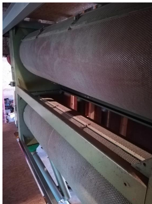
Abbildung 7: Siebanlage (linkes Bild) und Trieurmäntel (rechtes Bild) der Saatgutaufbereitung auf Gut Mönchhof
