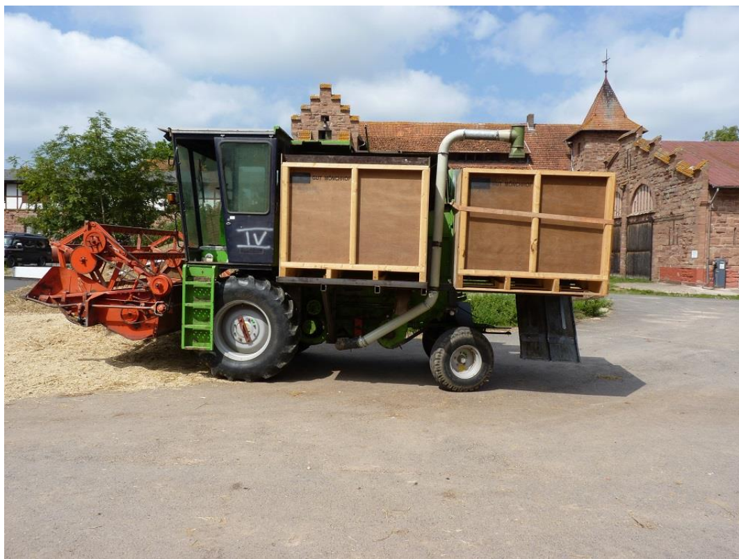
Abbildung 8: Modifizierter Baural-Mähdrescher mit Saatgutkisten
