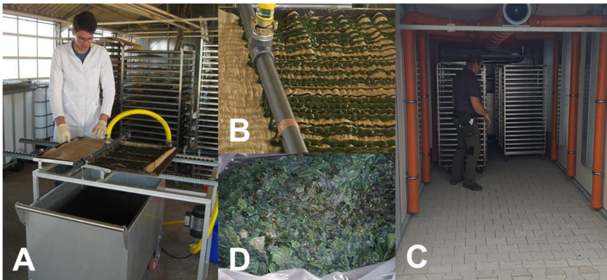
Abbildung 7: Verarbeitung der feuchten Algenrohware unmittelbar nach Ernte. Einsatz des von der Firma NOVAgreen Projektmanagement GmbH entwickelten Extruders zur Herstellung von Algenspaghetti, welche auf Backbleche ausgebracht (A, B) in den Trocknungsprozess überführt werden. Trocknungscontainer (C) und trockene Algenchips (D).
