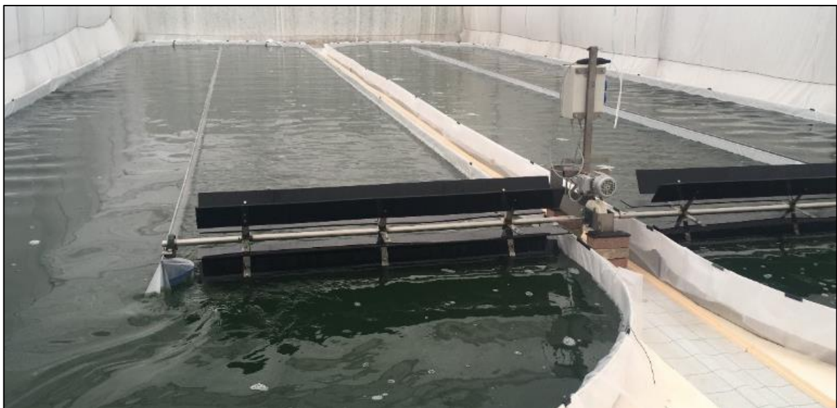
Abbildung 11: Raceway Pond-Systeme zur Kultivierung von Spirulina in der Produktionsanlage des Projektpartners RO-V-AL GbR.
