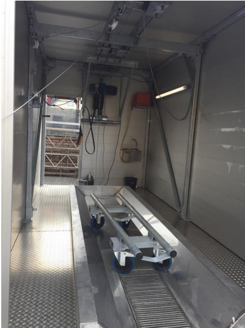
Abbildung 3 : Hänger von innen mit Schragen für die Anlieferung im stationärem Teil des Schlachtunternehmens. Winde und Hygieneinheit.
