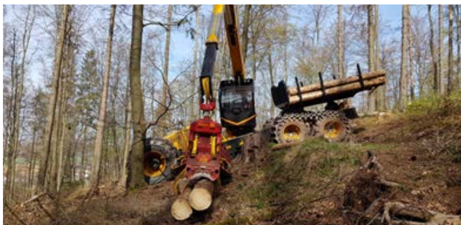
Abbildung 1 Harvander Highlander mit Traktionswinde und Rungenkorb
