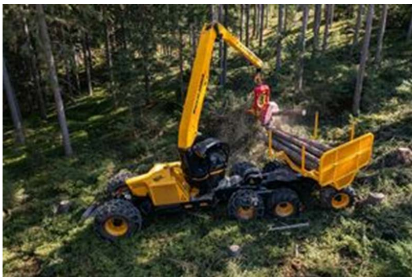
Abbildung 23 – Weiterentwicklung eines Harvarders auf Basis des Highlander (Quelle: Fa. Konrad Forsttechnik GmbH)
