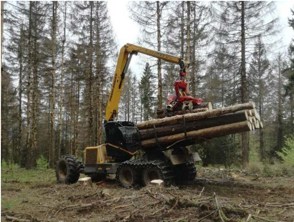
Abbildung 5 Highlander HL20-1 mit Traktionswinde und Rungenkorb
