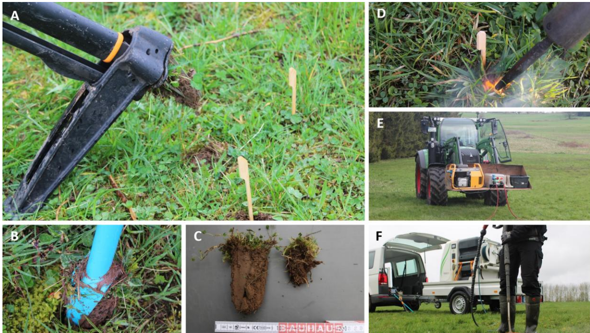
Abbildung 12: A Fiskars Ausstecher B Gardena Ausstecher C Unterschied Bodenkern Gardena-Ausstecher (li) und Fiskars Ausstecher (re) D Strombehandlung mit der Rootwave Handheld Pro E Stromaggregat zur Rootwave F Heißwasserbehandlung mit Oeliatec Houat 500
