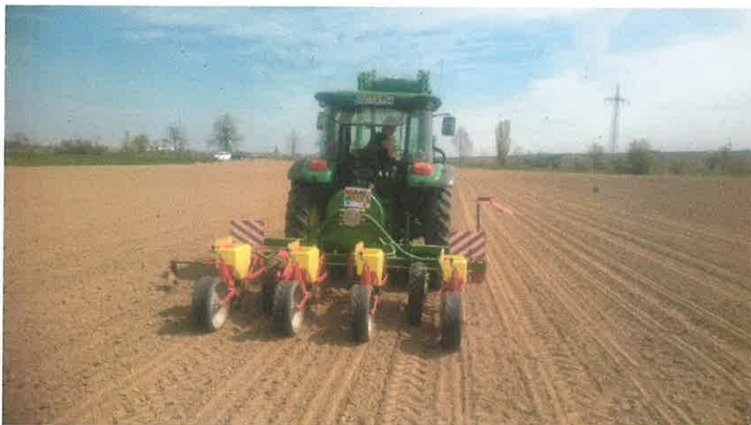
Abb. 3: Aussaat der Sonnenblumen mit vierreihiger, pneumatischer Einzelkornsämaschine am Standort Oelsitz, 2020. Auch für den Mais wurde diese Technik genutzt (Foto: H. Scharfstädt 2020)
