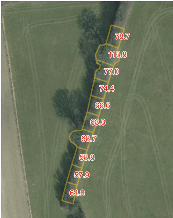
Abbildung 15: 2D Auswertung in Form von Flächenberechnung der Kronenbreiten jedes Segmentes des Objektes „Knick 5“; die Zahlen geben die Fläche der manuell eingezeichneten Polygone in m 2 an.
