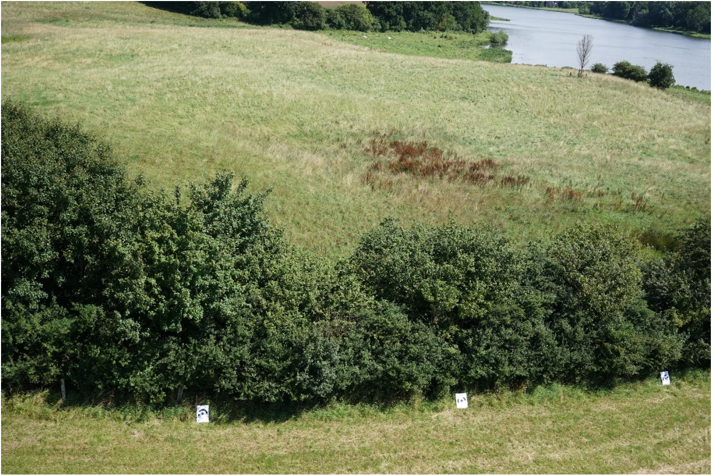
Abbildung 4: Typisches Foto aufgenommen vom Octocopter mit drei Ground Control Point (GCP) vor dem Gehölz, Beispielobjekt „Knick 7“
