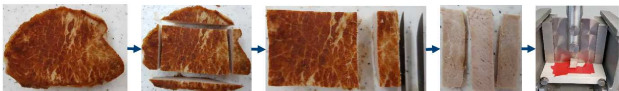
Abbildung 2: Darstellung der Probenvorbereitung der Scherkraft-Messungen mit der Warner-Bratzler-Scherzelle.
