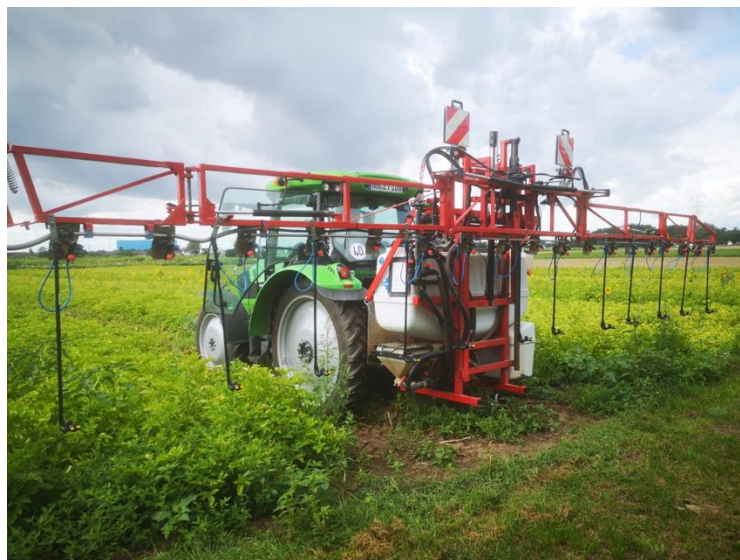
Abbildung 1: Versuchsspritze der Feldversuchsstation Groß-Gerau ausgerüstet mit dem Dropleg UL -System von Lechler GmbH. (eigene Aufnahme)
