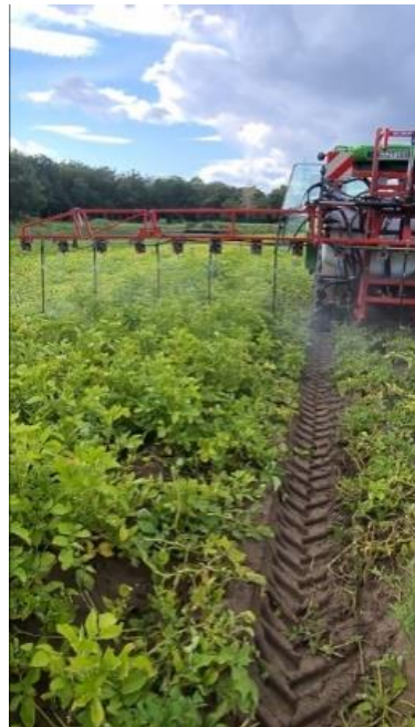
Abbildung 10: Dropleg UL -Anwendung in Kartoffeln (eigene Aufnahme)
