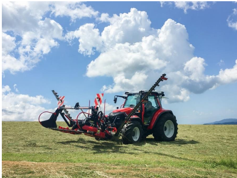
Abbildung 2: Doppelmesserbalken der Firma BB-Umwelttechnik GmbH als Front-Schmetterlingskombination. (Quelle: BB Umwelttechnik GmbH).
