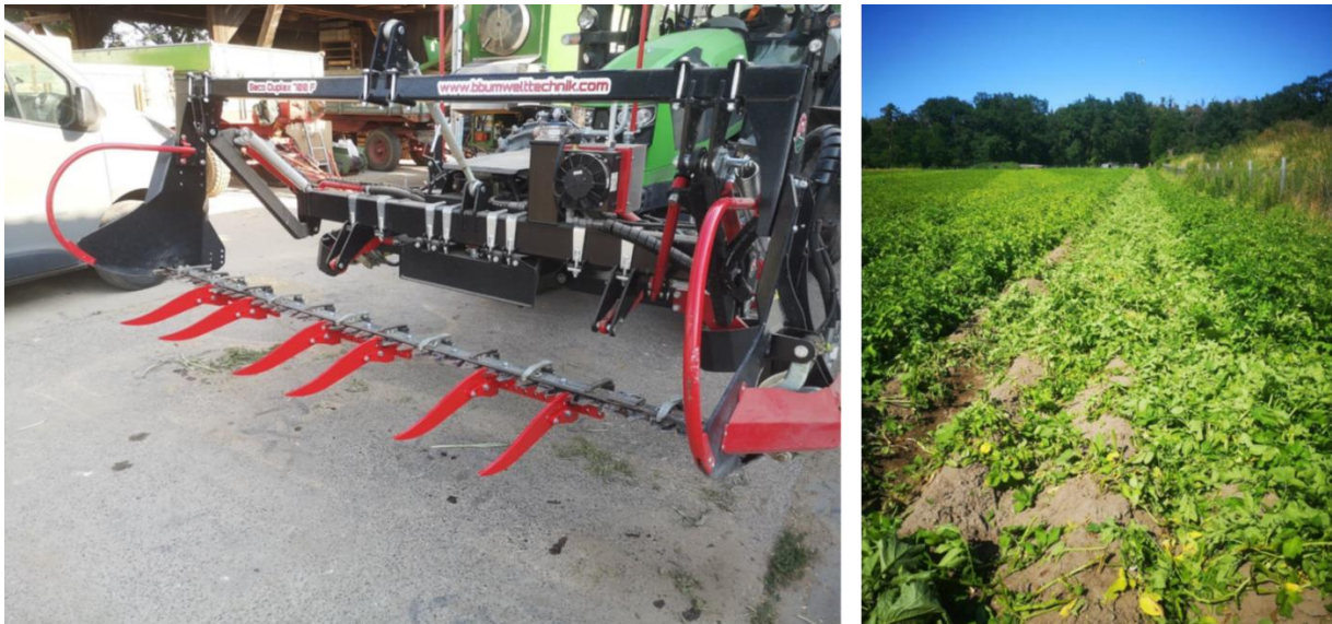
Abbildung 13: Doppelmesserbalken des Landtechnikunternehmens BB-Umwelttechnik GmbH ausgestattet mit Krauthebern, um eine Aufnahme der liegenden Krautanteile zu ermöglichen sowie Schnittergebnis nach einer Überfahrt.
