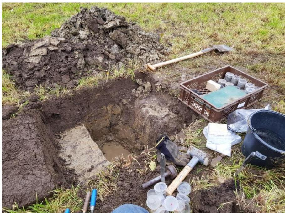
**Abbildung 4:** Mithilfe von Stechzylindern wurden ungestörte Bodenproben entnommen.
