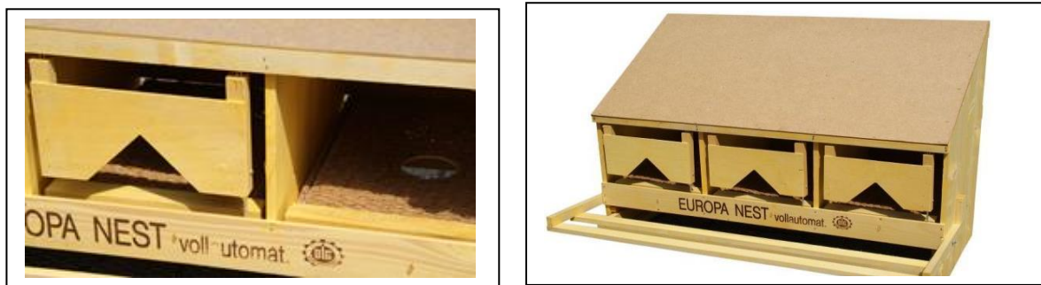
Abbildung 6: Nest mit 3 Legestellen. Der Legeboden ist mit einem Abrollmechanismus ausgestattet, die Eiersammeln sich im Eierfang unter dem Nest. [Alle Bilder mit freundlicher Genehmigung der Siepmann GmbH.]
