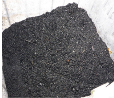
Bild 40: erzeugte Pflanzenkohle mit Kontiki
