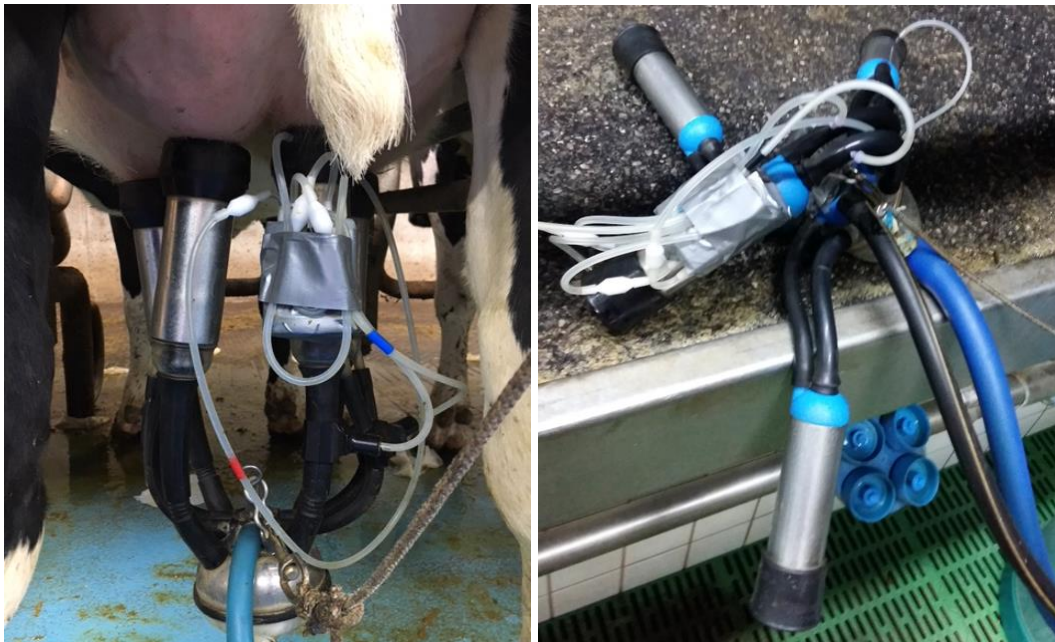
Abbildung 1: Messung der Vakuumhöhe beim Melken an vier Messpunkten im Melkzeug (Messgerät: VaDia 2.0, BioControl AS; Norwegen) (Bilder: D. Meyer, F. Kalisch)
