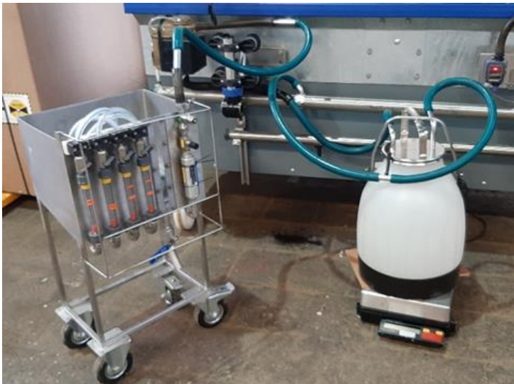
Abbildung 16: Kalibrierung der Durchflussmenge des mobiles künstlichen Euters an der Versuchsmelkanlage des Instituts für Landwirtschaftliche Verfahrenstechnik, CAU Kiel (Bild: J. von der Heyde)
