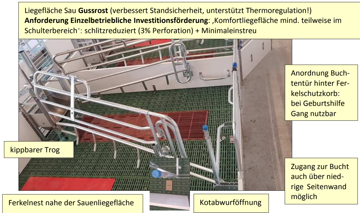
Abbildung 16: aus dem Projekt heraus konzipierte Bewegungsbucht für den Umbau der Sauenzuchtanlage Bayern
