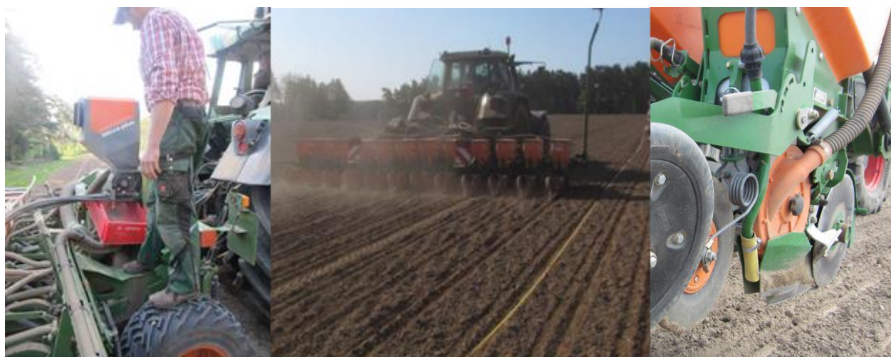
Abb. 1: Versuchsanlage in V575 mit Abdreprobe am aufgesatteltem Mikrogranulatstreuer (li.) sowie veränderter Zuführung des Granulats zum Saatband (re.).
