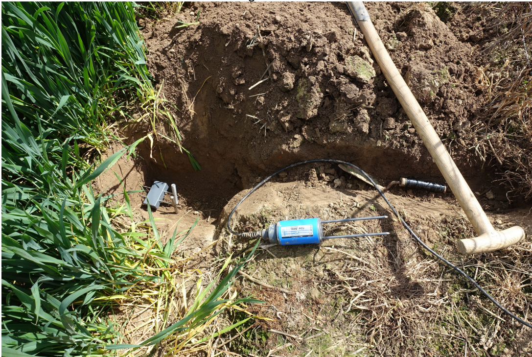
Abbildung 2: TDR Sonde TRIME PICO zur Messung der Bodenfeuchte und der Bodentemperatur
