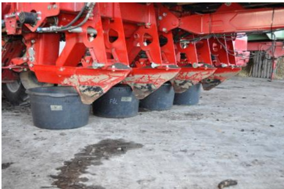
Abbildung 9: Auffangen des Kompostes bei der Messung der Querverteilung. (van Woudenberg, 2019)
