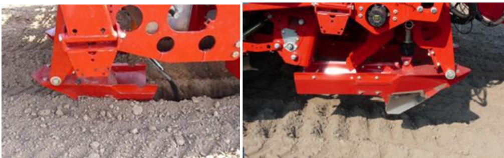
Abbildung 4: Modifikation des Furchenziehers durch die Firma Grimme. Links: der Furchenzieher des ersten Prototyp der Universität Kassel (Bohne et al., 2011). Rechts: Der Furchenzieher mit verlängerten Leitblechen nach der Modifikation durch die Firma Grimme (Block, 2014).
