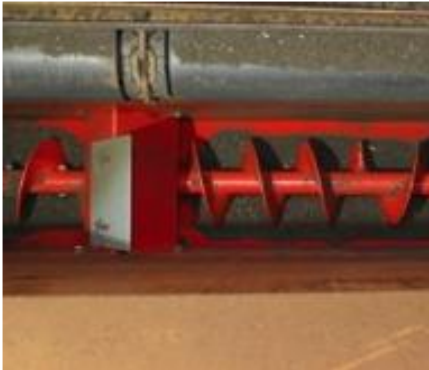
Abbildung 14: Mit Langlöchern auf die Auslassdrehsehnecke verschraubte Leitbleche zur Lenkung des Kompoststroms (Van Woudenberg 2019).
