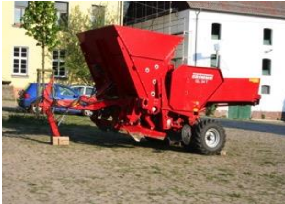
Abbildung 3: Modifikation des ersten Prototyps durch die Firma Grimme. Der Kompostbunker wurde vergrößert und die Maschine wurde auf vier reihige Arbeitsweise erweitert (Van Woudenberg, 2019).
