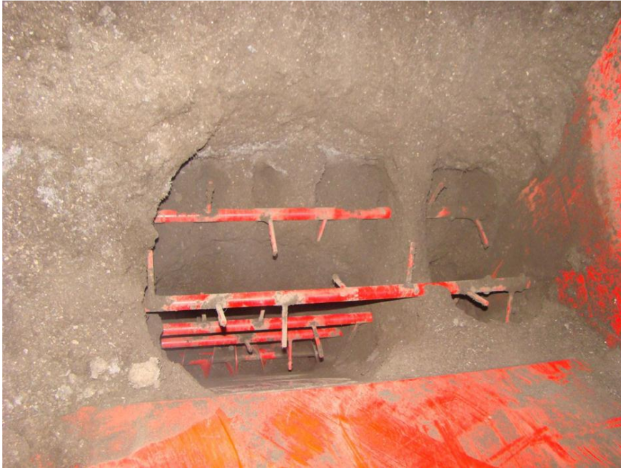
Abbildung 5: Die veränderten Rührwellen im von Firma Grimme modifizierten Prototyps können die Brückenbildung des Kompostes nicht verhindern. (Block 2014)
