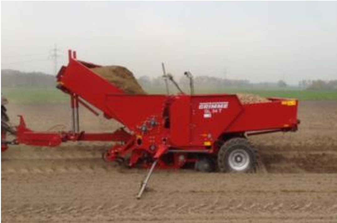
Abbildung 6: Der zweite Prototyp einer kombinierten Kompostapplikations-Kartoffelpflanzmaschine mit einem Kippbunker. Die Maschine wurde von Firma Grimme konstruiert und gebaut. Firma Grimme stellte diesen Prototypen auf der Agritechnica 2013 unter dem Namen „CompoStar“ vor. (Block, 2014)
