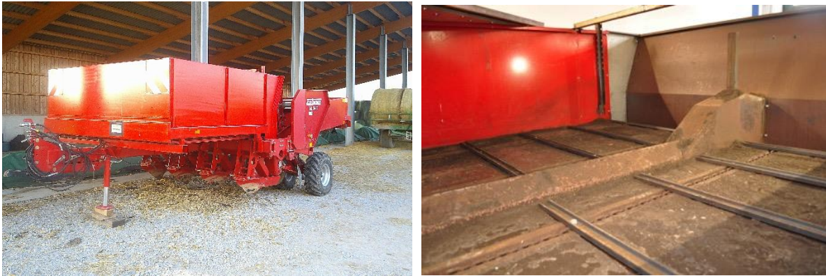
Abbildung 11: Linke Seite: Der dritte Prototyp der kombinierten Kompostapplikations- Kartoffelpflanzmaschine. Rechte Seite: Detailansicht des Kratzbodens mit Kettengeführten Kratzbodenleisten zum Transport des Materials zur Dosiereinheit.
