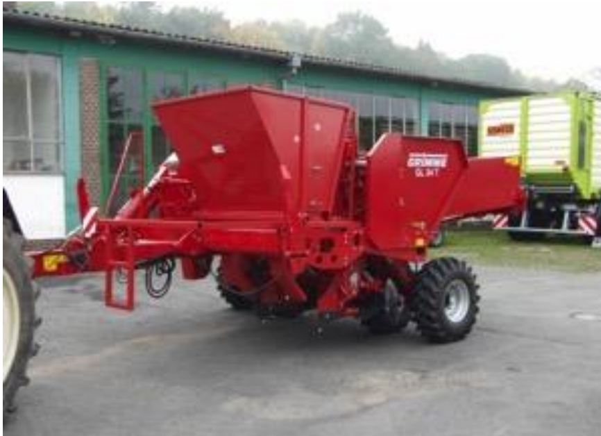
Abbildung 2: Erster Prototyp einer kombinierten Kompostapplikations-Kartoffelpflanzmaschine der Universität Kassel aus dem Jahr 2009. (Bohne et al, 2011)
