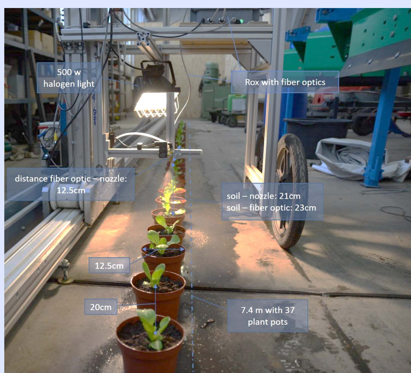
Versuchsstand mit integriertem RoX Hyperspektralsensor sowie einer zusätzlichen Lichtquelle, um mit Freilandbedingungen vergleichbare Lichtintensitäten zu erzeugen. In Töpfen gepflanzte Salatjungpflanzen im Abstand von 20 cm entsprechen der Pflanzenposition im Feld.
