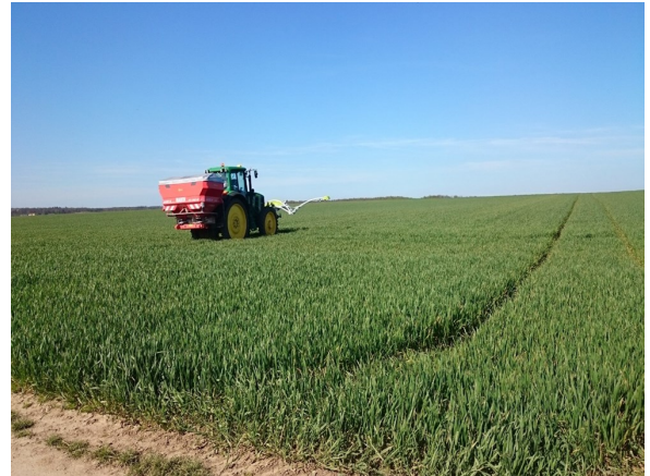
Bild 1: Einsatz eines N-Sensors im Projekt zur verbesserten N-Dosierung im Weizenfeld
